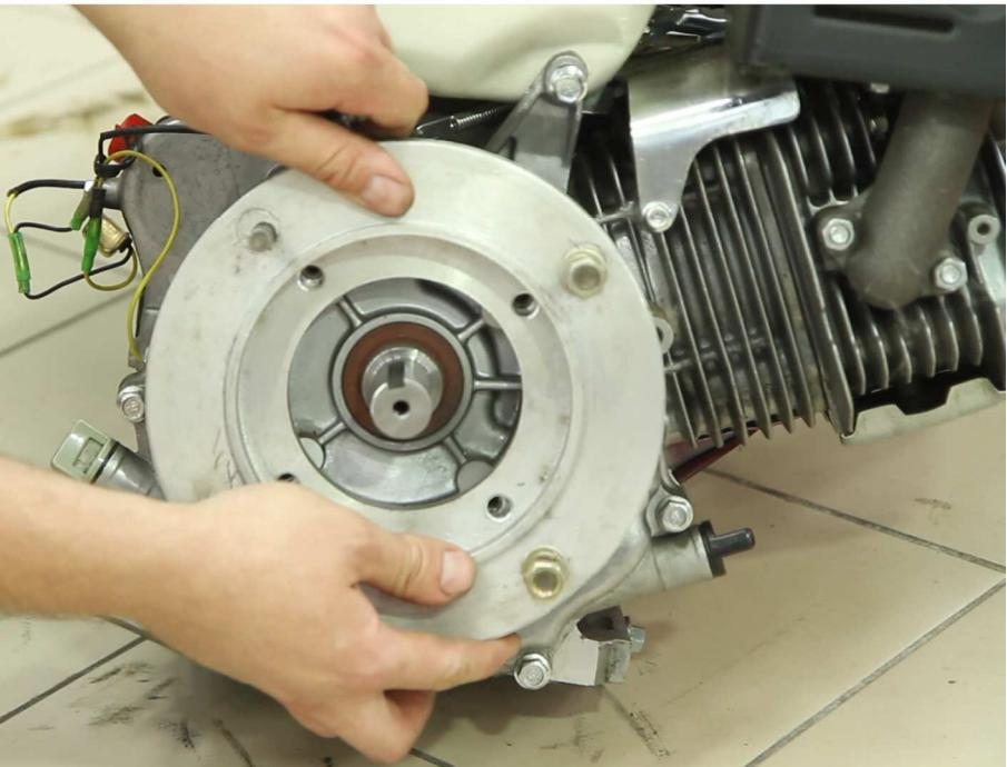
Установите переходную втулку, шпонку и муфту сцепления. Закрепите болтом M8 с усиленной шайбой.
