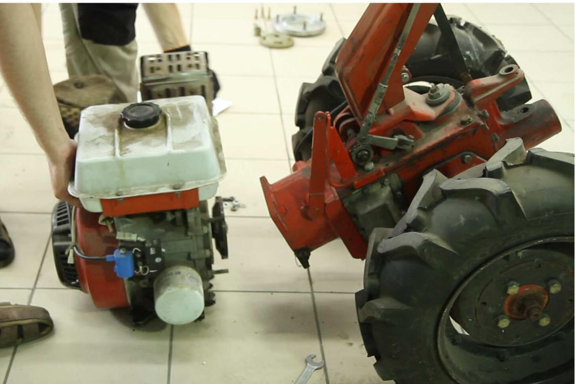
**Открутив четыре болта, снимите муфту сцепления. В последующем эта муфта будет прикручена к новой муфте сцепления из установочного комплекта.**
