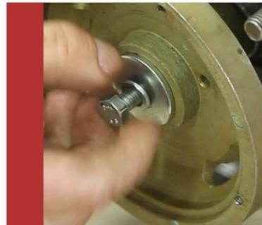
Затем установите муфту сцепления со старого двигателя, в обратном порядке. Убедитесь в надежности каждого резьбового соединения.
