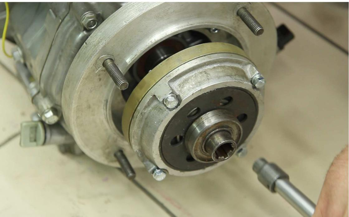
Теперь новый двигатель можно установить на трансмиссию мотоблока, надежно затянув все четыре гайки.
