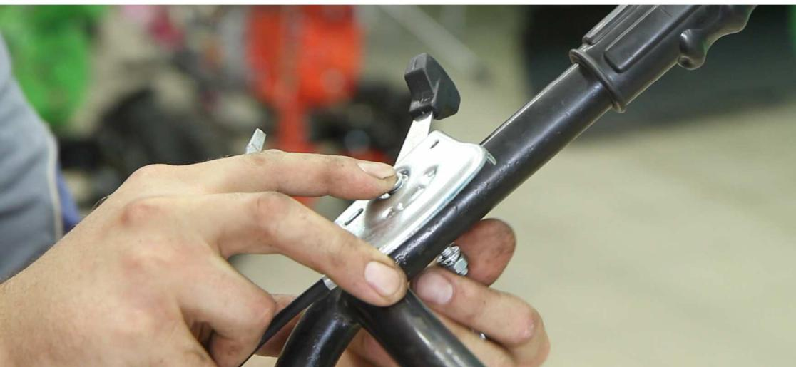
**Затем закрепите конец троса на рычаге газа двигателя.**
