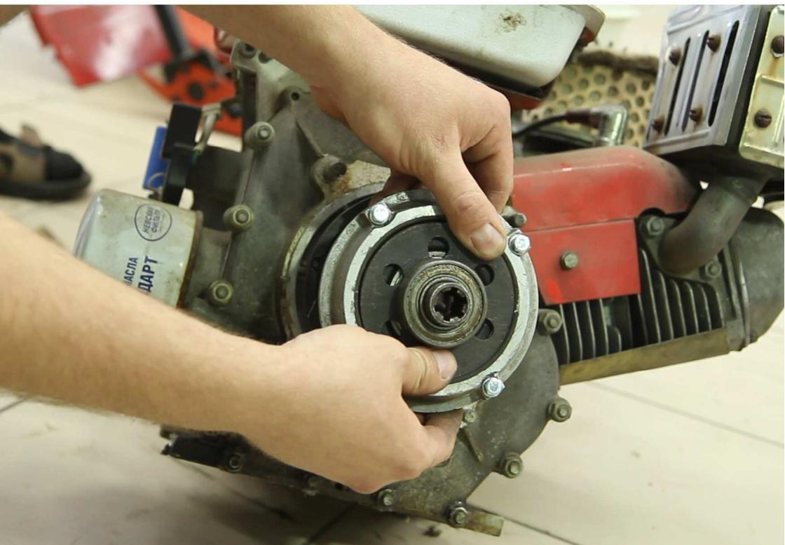
**Установите фланец на новый двигатель, надежно закрепив его болтами M8 с шестигранной внутренней головкой. Тщательно затяните каждое соединение.**
